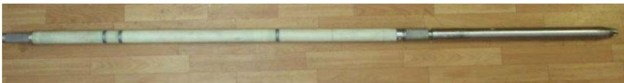
Рисунок 4.2 – Комплексный скважинный прибор КСП-48МКС
